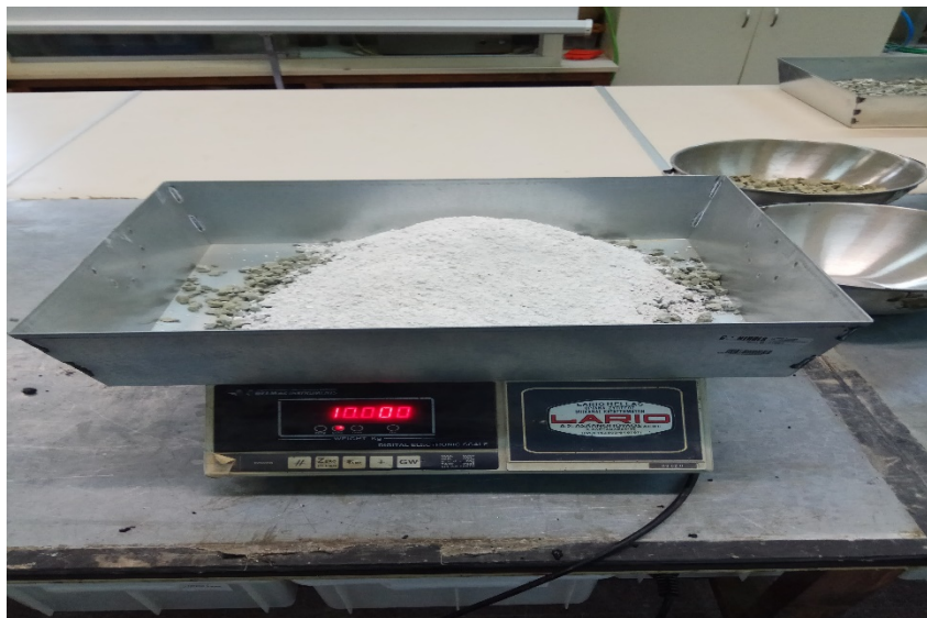
Εικόνα 6.4 Μίγμα αδρανών πριν την ανάμιξή τους
