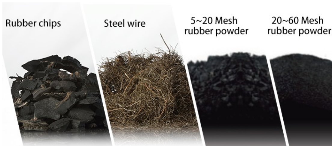
Εικόνα 3.10 Προϊόντα ανακύκλωσης ελαστικών
