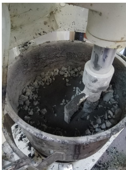
Εικόνα 6.15 Ανάδευση για 10-20sec του ελαστικού στα ξηρά αδρανή
