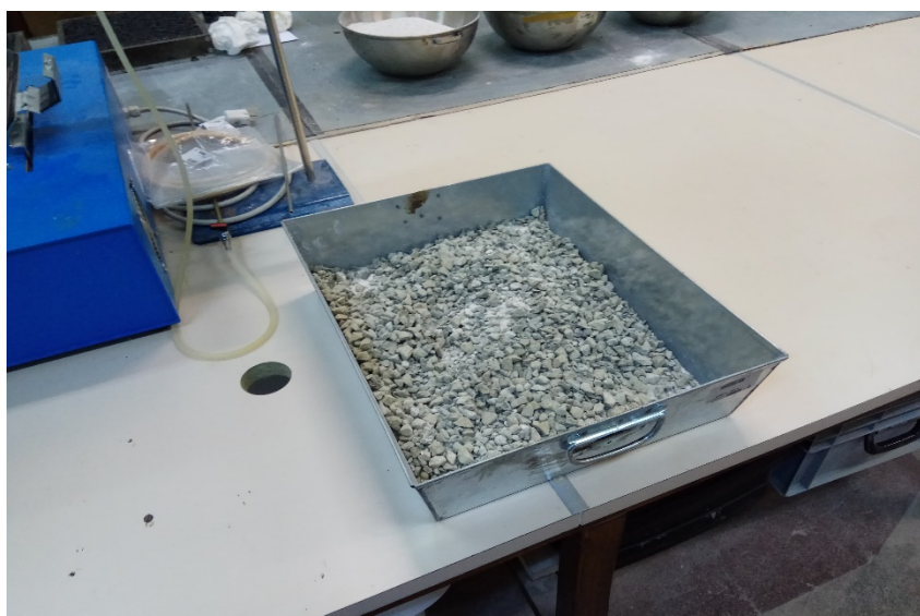
Εικόνα 6.4 Μίγμα αδρανών πριν την ανάμιξή τους
