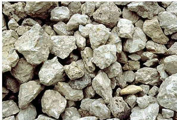
Εικόνα 2.4 Ανακυκλωμένα αδρανή σκυροδέματος
