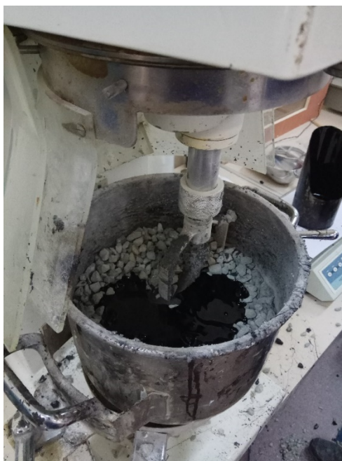
Εικόνα 6.7 Ανάδευση ασφάλτου στο μίγμα αδρανών
