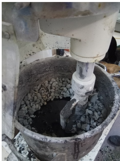
Εικόνα 6.16 Εισαγωγή θερμής ασφάλτου στο μίγμα, αμέσως μετά την ανάδευση του ελαστικού σε αυτό
