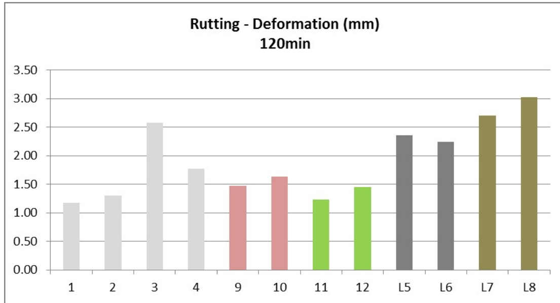
Εικόνα 5.16 Αποτελέσματα δοκιμής τροχοαυλάκωσης όπου τα μίγματα 1-12 είναι με προσθήκη RAR, τα L5-L6 είναι μίγματα ασφαλτικής σκυρομαστίχης με AMBS και τα L7-L8 είναι μίγματα ασφαλτικής σκυρομαστίχης με ίνες (Sousa, 2012)
