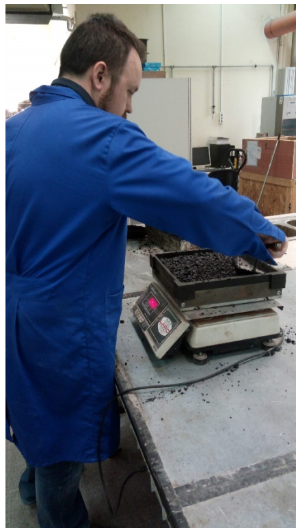
Εικόνα 6.11 Εισαγωγή ασφαλτομίγματος στην μήτρα
