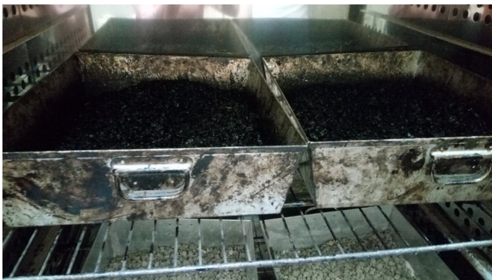
Εικόνα 6.9 Μίγματα στον φούρνο του εργαστηρίου για θέρμανση 1 ώρας στους 170-180°C
