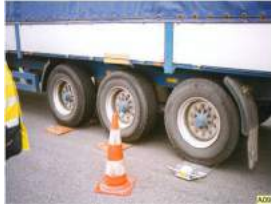
Εικόνα 1.3: Φορητές στατικές ζυγαριές τροχών
