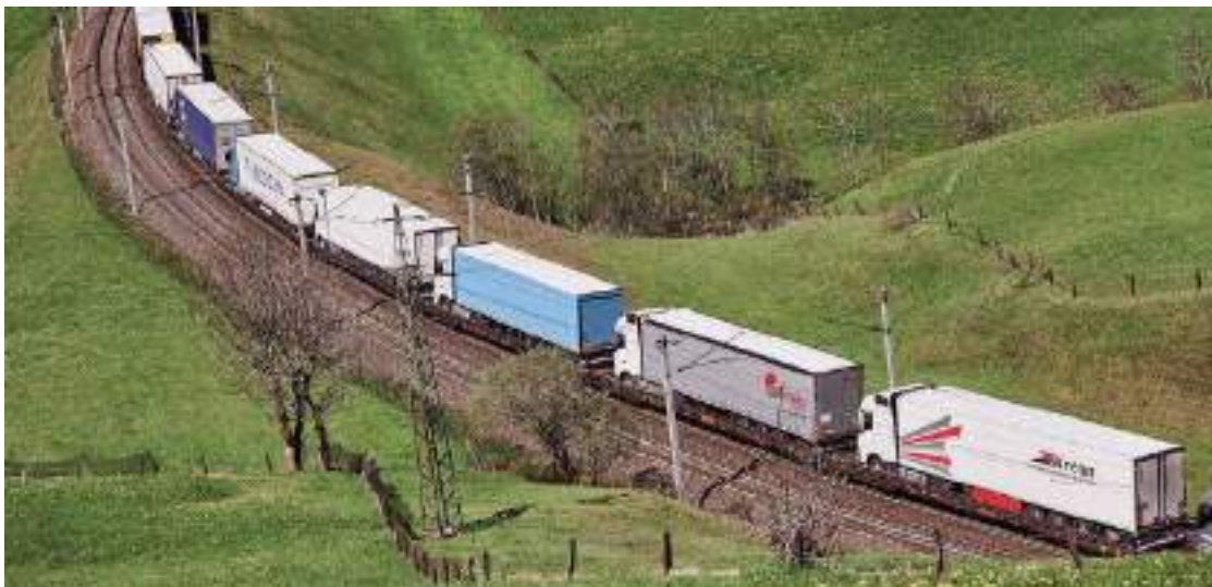
Εικόνα 21 Φόρτωση με το σύστημα Ro-LA 73
