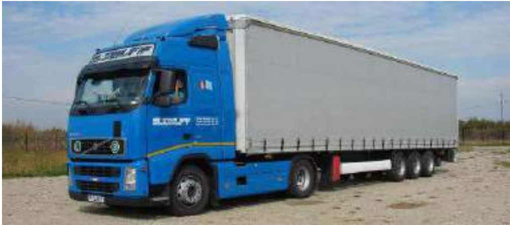
Εικόνα 4 Συμβατικό τριαξονικό όχημα διεθνών μεταφορών 54
