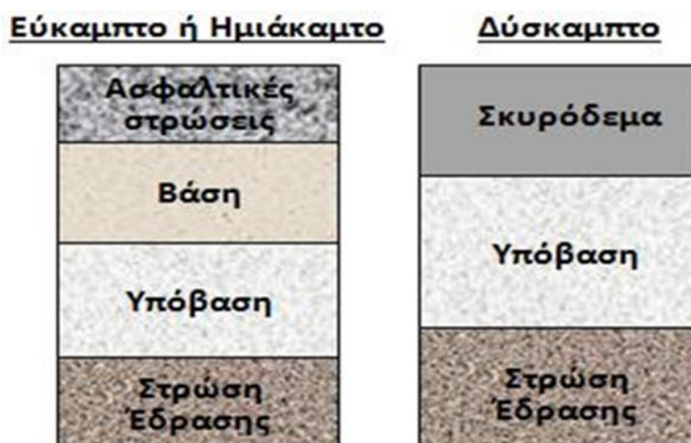
Εικόνα 6 Διατομές οδοστρωμάτων.
