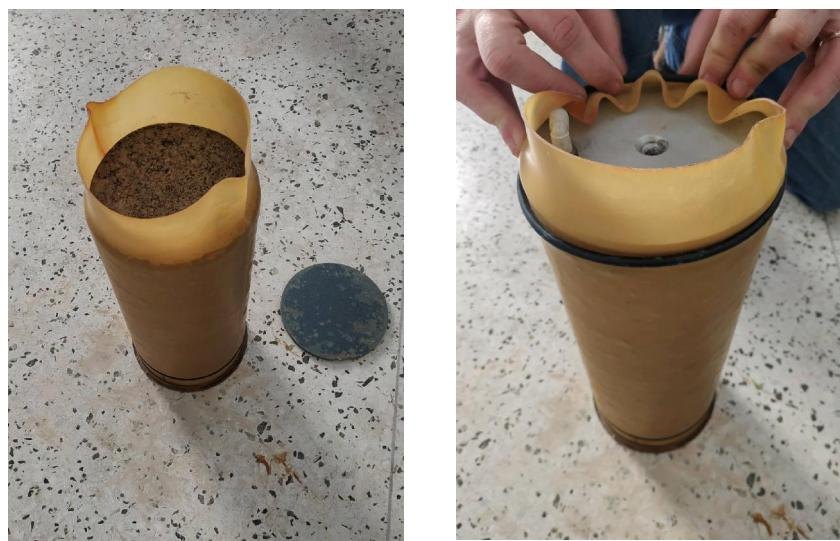
Εικόνα 6.17 A. Δοκίμιο πριν την τοποθέτηση πορώδη δίσκου. B. Δοκίμιο με τοποθέτηση ειδικού μεταλλικού καπακιού.
