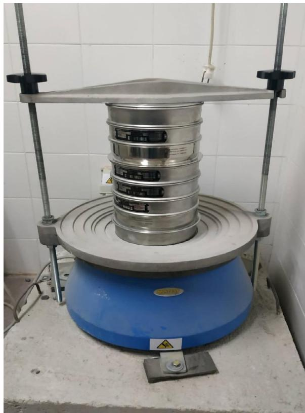
Εικόνα 6.2 Συσκευή δόνησης
