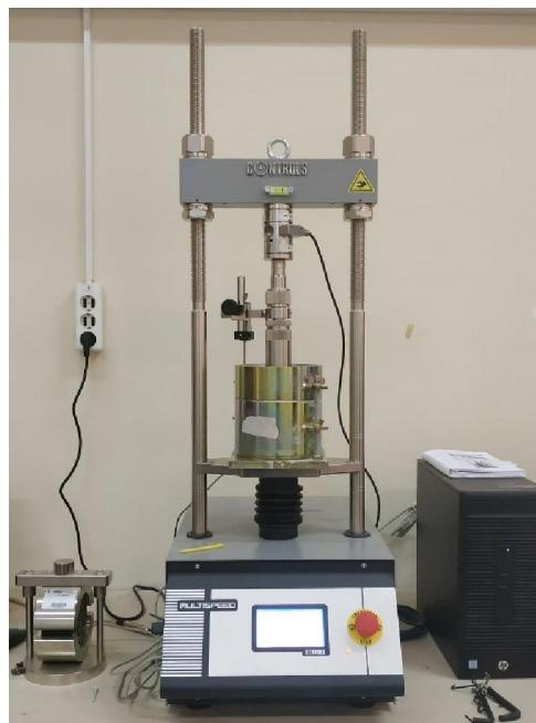
Εικόνα 6.15 Συσκευή δοκιμής CBR
