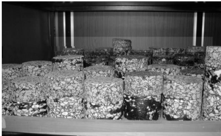
Εικόνα 2.16. Πυρήνες ασφαλτομίγματος στο εργαστήριο
