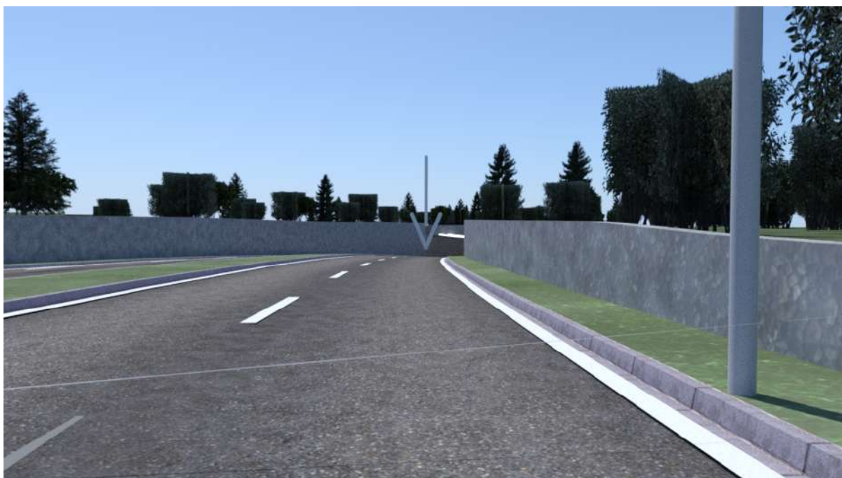
Εικόνα 6.10 - Στιγμιότυπο από βίντεο - Προοπτική απεικόνιση καθώς το όχημα κινείται πάνω στην καμπύλη (Υπόγεια Διάβαση) (ταχύτητα 50km/h – εμπόδιο στα 44m)
