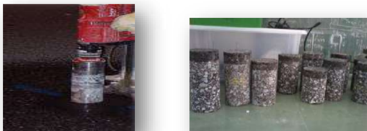
Εικόνα 2.5 : Πυρηνοληψία και πυρήνες ασφαλτομίγματος στο εργαστήριο.
