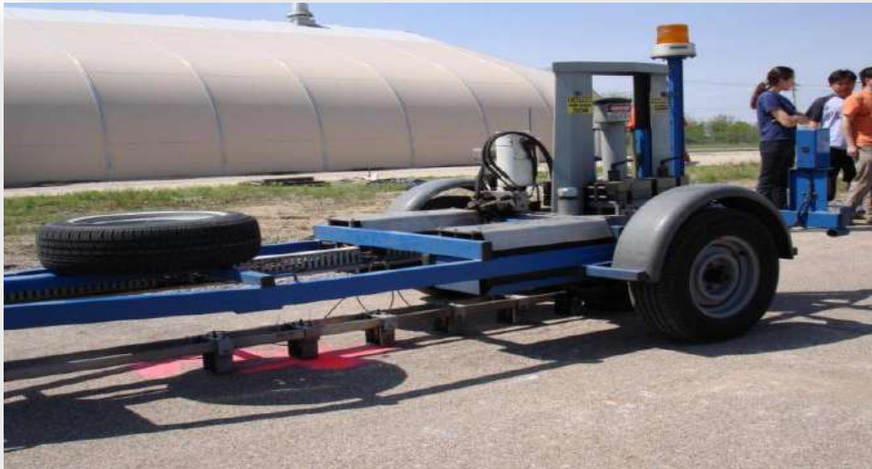
Εικόνα 2.12: Παραμορφωσίμετρο πίπτοντος βάρους FWD , (Tutumluer&Pekcan ,2009).
