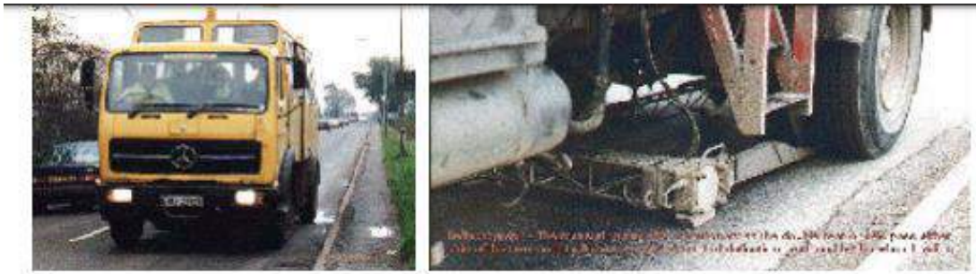
Εικόνα 2.9: Συστήματα επιβολής στατικού φορτίου, deflectograph
