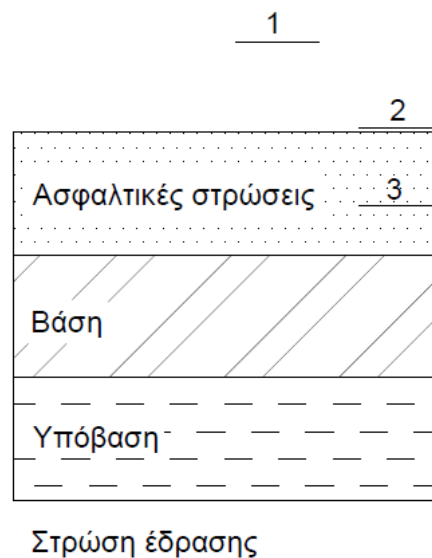
Εικόνα 4.3: Μέτρηση Θερμοκρασίας: (1) αέρα (2) επιφάνειας οδοστρώματος, (3) ασφαλτικών στρώσεων
