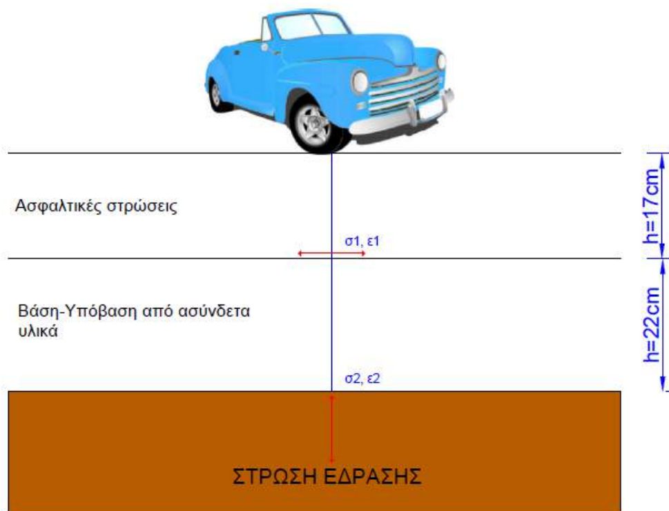
Εικόνα 5.2: Διατομή οδοστρώματος
