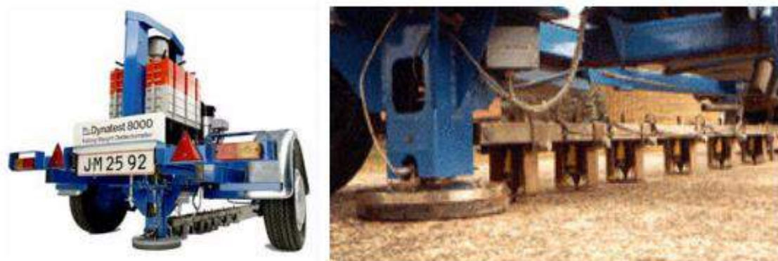
Εικόνα 2.11: Συστήματα επιβολής δυναμικού φορτίου, FWD
