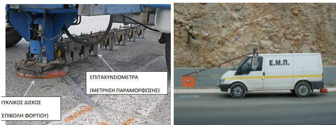
Εικόνα 3.1: Παραμορφωσίμετρο προσπίπτοντος Βάρους
