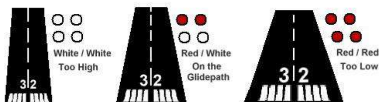
Σχήμα 3.42: Ενδείξεις του T – VASIS και AT-VASIS, ανάλογα με το ύψος προσέγγισης
