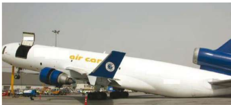
Σχήμα 3.3: Παράδειγμα ανατροπής ουράς αεροσκάφους
