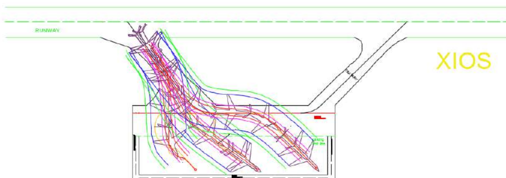
Σχήμα 4.19: Τροχιά αεροσκάφους κατά την έξοδό του από τον τροχόδρομο 1 για στάθμευσή του σε μία από τις θέσεις στάθμευσης στο δάπεδο του αεροδρομίου της ΧΙΟΥ (για στάθμευση υπό γωνία 45°)
