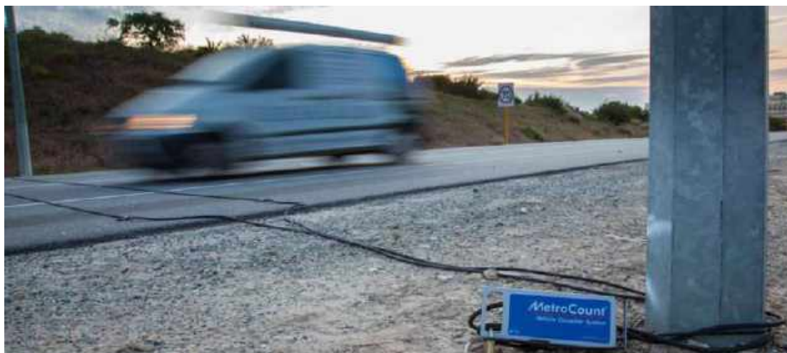
Εικόνα 4-7 Εύκαμπτοι ελαστικοί σωλήνες για την μέτρηση της κυκλοφορίας (Φωτογραφία από το διαδίκτυο https://d3ujymhvw3jd.cloudfront.net/wp-content/uploads/2016/05/IMG_8595.jpg )
