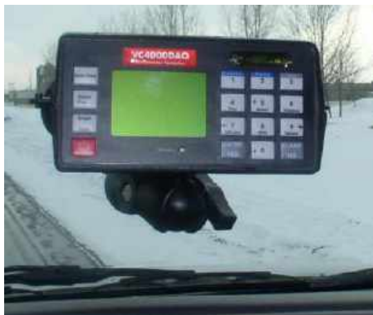
Εικόνα 4-9 Επιταχυνσιόμετρο Vericom VC4000DAQ (Εικόνα από τα διαδίκτυο: https://cdn.masstransitmag.com/files/base/cygnus/mass/image/2015/05/960w/10x7_cropped.55689dab9b188.jpg )
