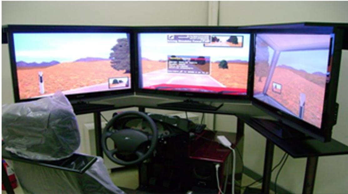
*Εικόνα 4.1: Φωτογραφία του προσομοιωτή οδήγησης (Driving Simulator FPF)*
