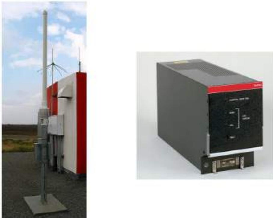
**Εικόνα 2.7:** Αναμεταδότης DME εδάφους στο αεροδρόμιο της Στοντγάρδης (αριστερά) και ανακριτής DME εντός αεροσκάφους (δεξιά)
