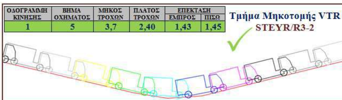
Εικόνα 6.16ii Απεικόνιση κίνησης οχήματος STEYR στην οδό R3 (R3-1, R3-2), μέσω VTR
