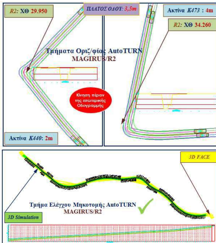
Εικόνα 6.43 Απεικόνιση κίνησης οχήματος MAGIRUS στην οδό R2 , μέσω AutoTURN
