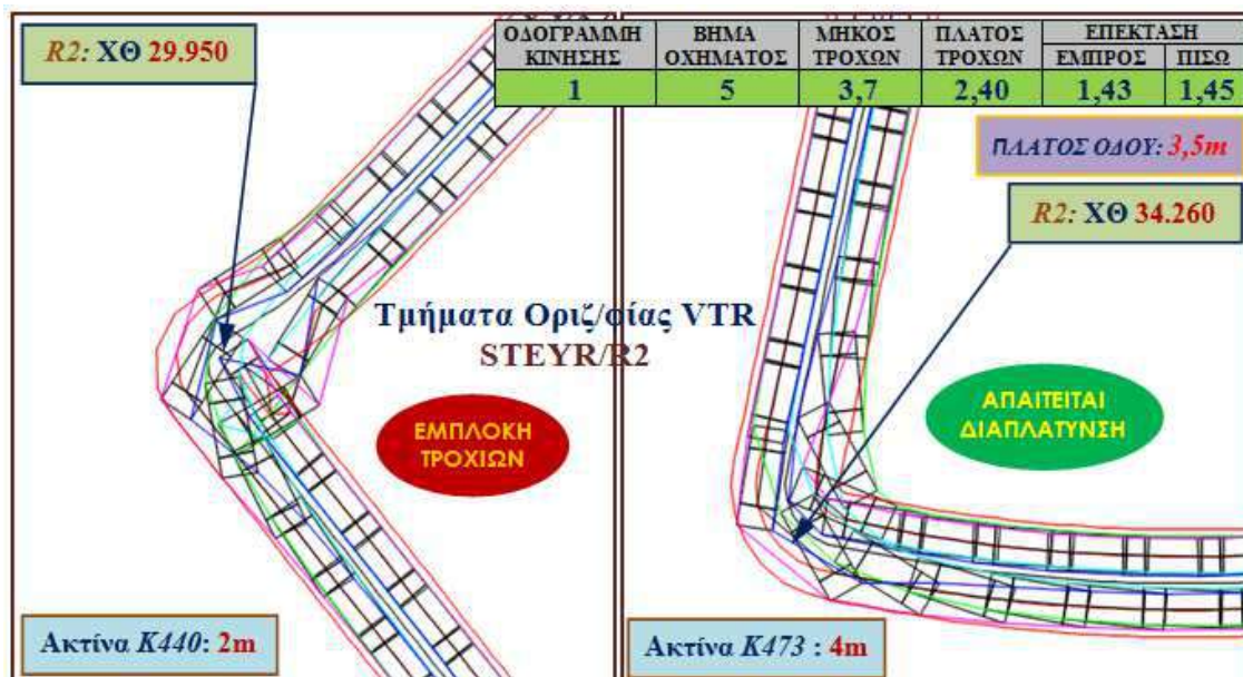
Εικόνα 6.15i Απεικόνιση κίνησης οχήματος STEYR στην οδό R2, μέσω VTR
