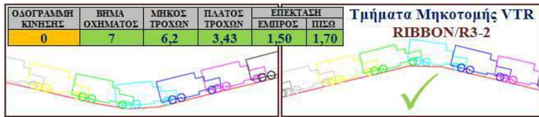
Εικόνα 6.24ii Απεικόνιση κίνησης οχήματος μτφ RIBBON στην οδό R3 (R3-1, R3-2), μέσω VTR
