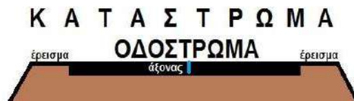
Σχήμα 2.3 Απεικόνιση Τομής Οδού (Άξονας Y)
