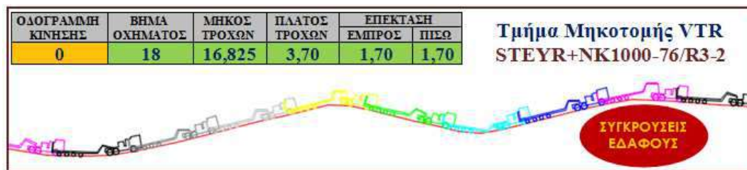
Εικόνα 6.32ii Απεικόνιση κίνησης οχήματος STEYR M60 με NK1000-76 στην οδό R3a, μέσω VTR
