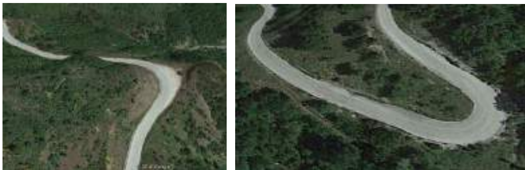
Εικόνες 3.1 & 3.2 Κυκλικά τόξα με διαπλάτυνση σε ορεινές δασικές περιοχές της Ελλάδος (πηγή : Google Earth)
