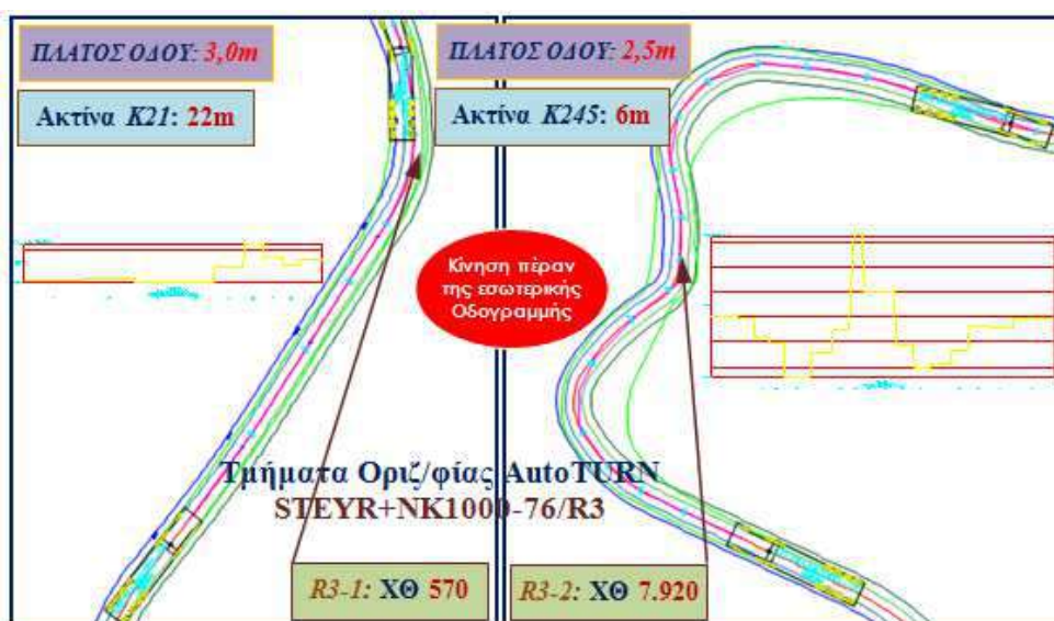
Εικόνα 6.56i Απεικόνιση κίνησης STEYR M60 με NK1000-76 στην οδό R3a , μέσω AutoTURN
