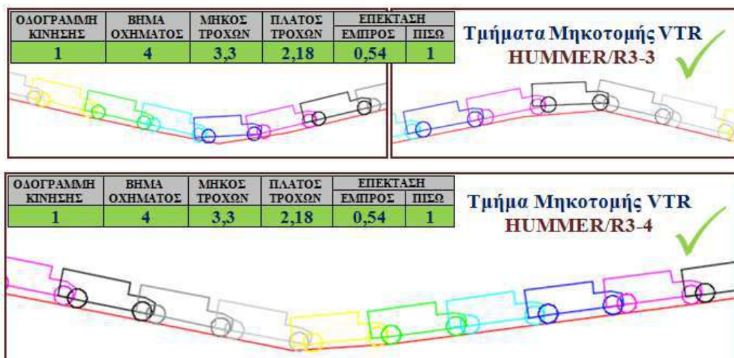
Εικόνα 6.13ii Απεικόνιση κίνησης οχήματος HUMMER στην οδό R3 (R3-3, R3-4), μέσω VTR
