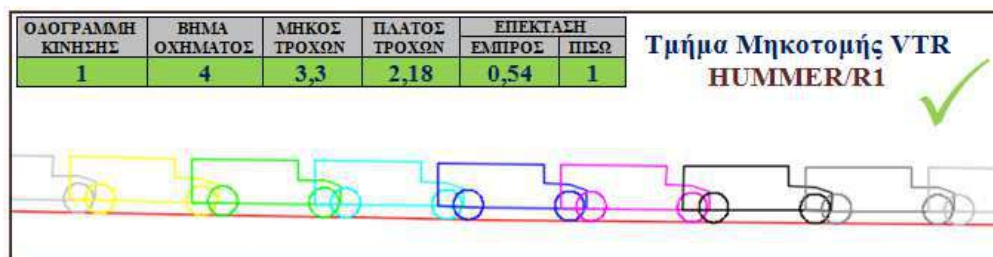
Εικόνα 6.10ii Απεικόνιση κίνησης οχήματος HUMMER στην οδό R1, μέσω VTR
