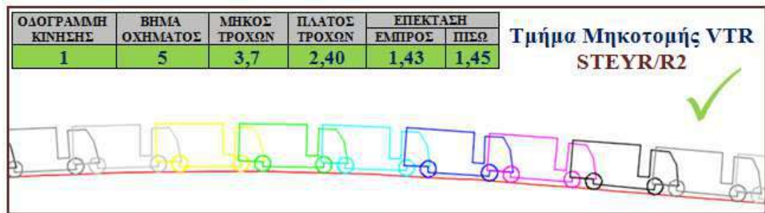
Εικόνα 6.15ii Απεικόνιση κίνησης οχήματος STEYR στην οδό R2 , μέσω VTR
