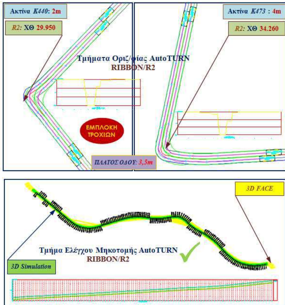
Εικόνα 6.47 Απεικόνιση κίνησης οχήματος μπρ RIBBON στην οδό R2 , μέσω AutoTURN
