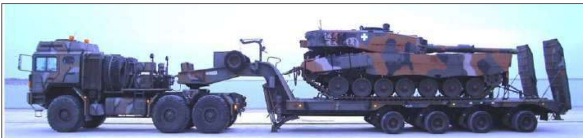
Εικόνα 4.70 Ρυμουλκό όχημα STEYER 40 M60/S40 με αρματοφορέα NK 1000-76 κατά τη μεταφορά άρματος μάχης LEOPARD 2 A6 HEL
