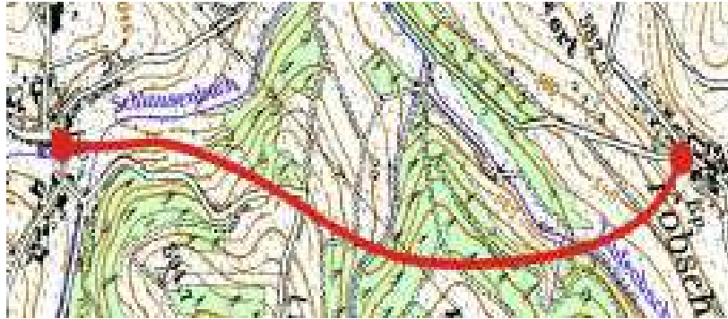
Εικόνα 4: Προτεινόμενη οριζοντιογραφική χάραξη για οδούς της ΕΚΛ 1 [1].
