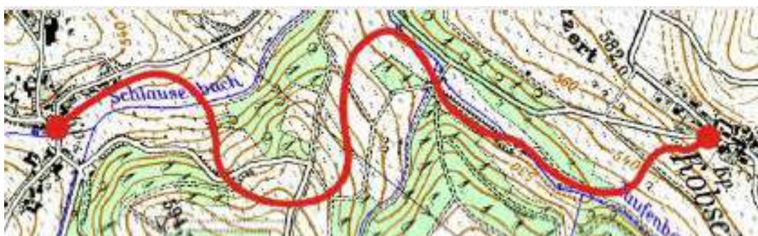
Εικόνα 9: Προτεινόμενη οριζοντιογραφική χάραξη οδούς της ΕΚΛ 4 [1].
