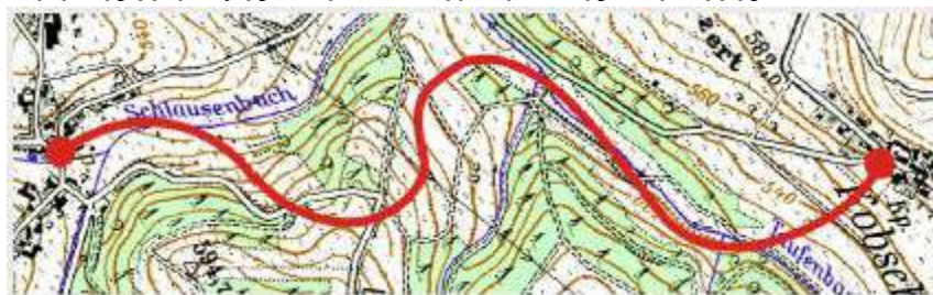
Εικόνα 7: Προτεινόμενη οριζοντιογραφική χάραξη για οδούς της EKL 3 [1].
