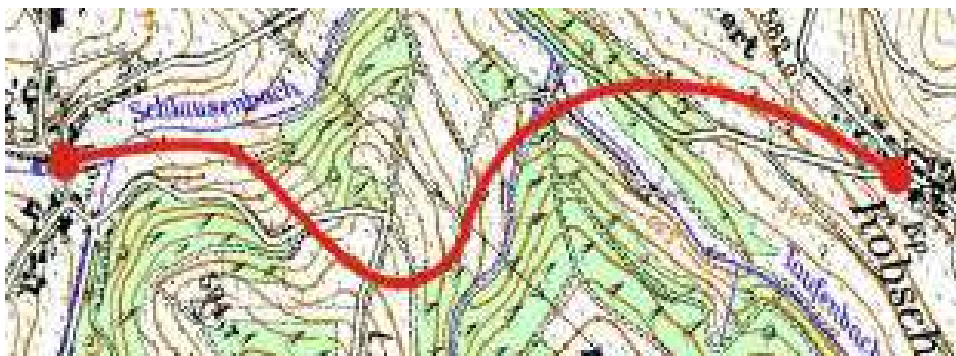
Εικόνα 6: Προτεινόμενη οριζοντιογραφική χάραξη για οδούς της EKL 2 [1].
