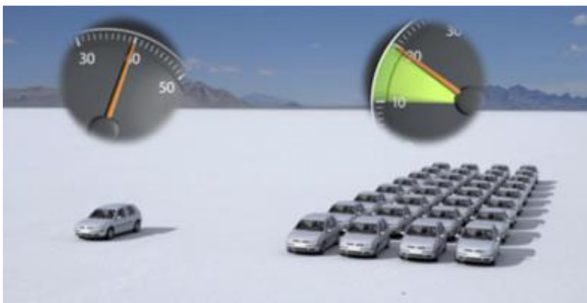
Εικόνα 1.1: Επίδραση οδήγησης σε υψηλές στροφές κινητήρα στον παραγόμενο θόρυβο (Πηγή: [15])
