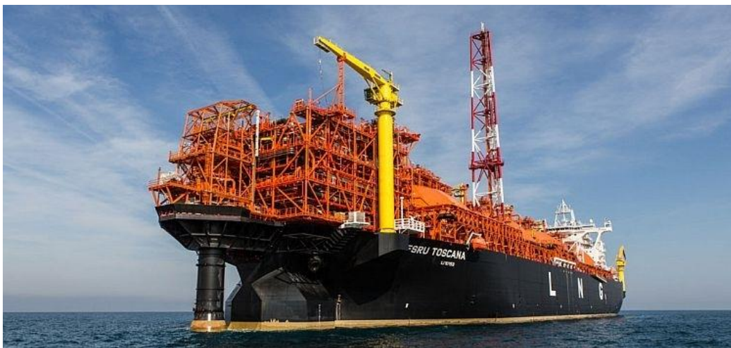
Εικόνα 26. Πλωτός τερματικός σταθμός LNG σε μόνιμα αγκυροβολημένο σκάφος
