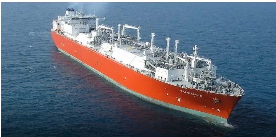
Εικόνα 27. Πλοίο μεταφοράς με εγκατεστημένη μονάδα επαναεριοποίησης στο κατάστρωμα του σκάφους
