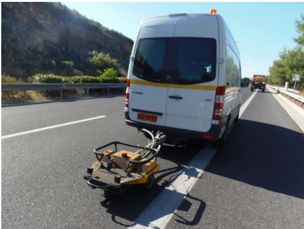
Εικόνα 2.25 Επιτόπου μέτρηση με το σύστημα Grip Tester του Εργαστηρίου Οδοποιίας ΕΜΠ.
