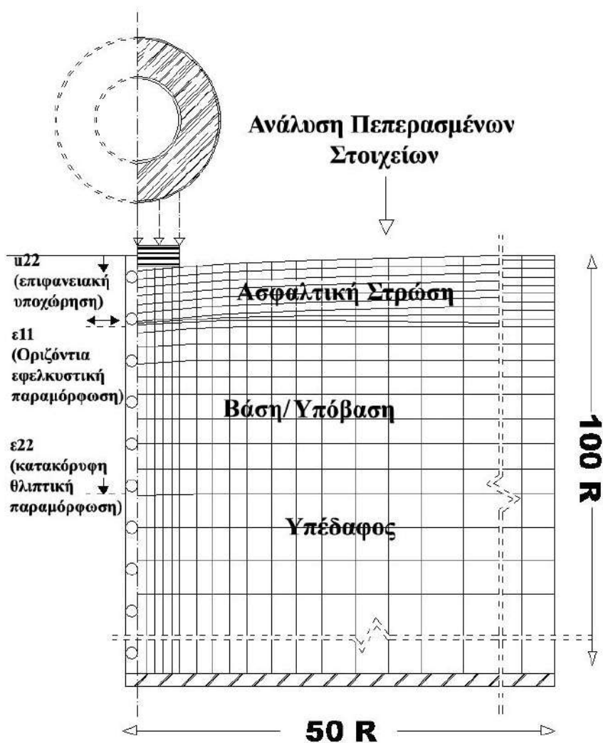
Σχήμα 32: Κρίσιμες θέσεις ελέγχου τάσεων και παραμορφώσεων στη διατομή ελέγχου.
