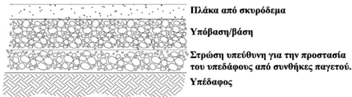
Σχήμα 2: Τυπική διατομή δύσκαμπτου οδοστρώματος.
