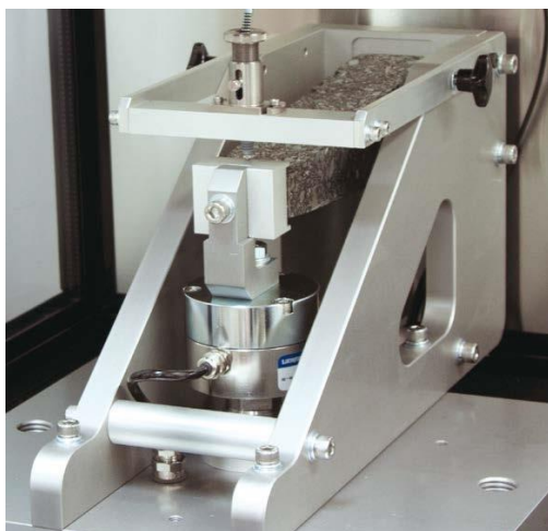
Εικόνα 5.4: Δοκιμή κάμψης δύο σημείων τραπεζοειδούς δοκιμίου
