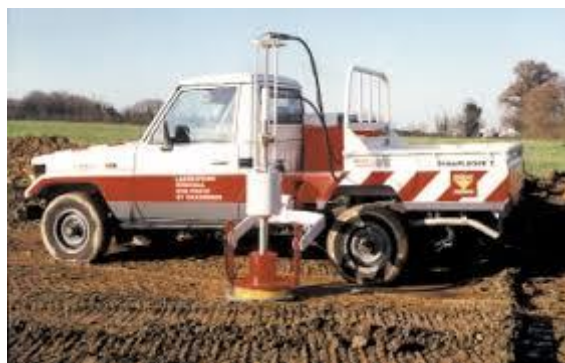
Εικόνα 5.3: Συσκευή LPC Dynaplaque (Balay et al., 2012)
