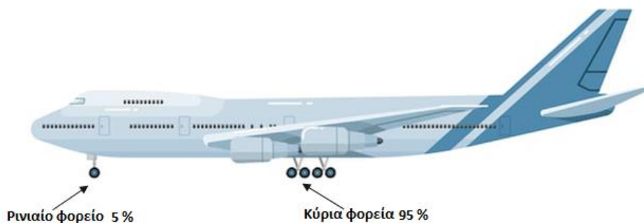
Σχήμα 2.2: Κατανομή βάρους αεροσκάφους στα φορεία
