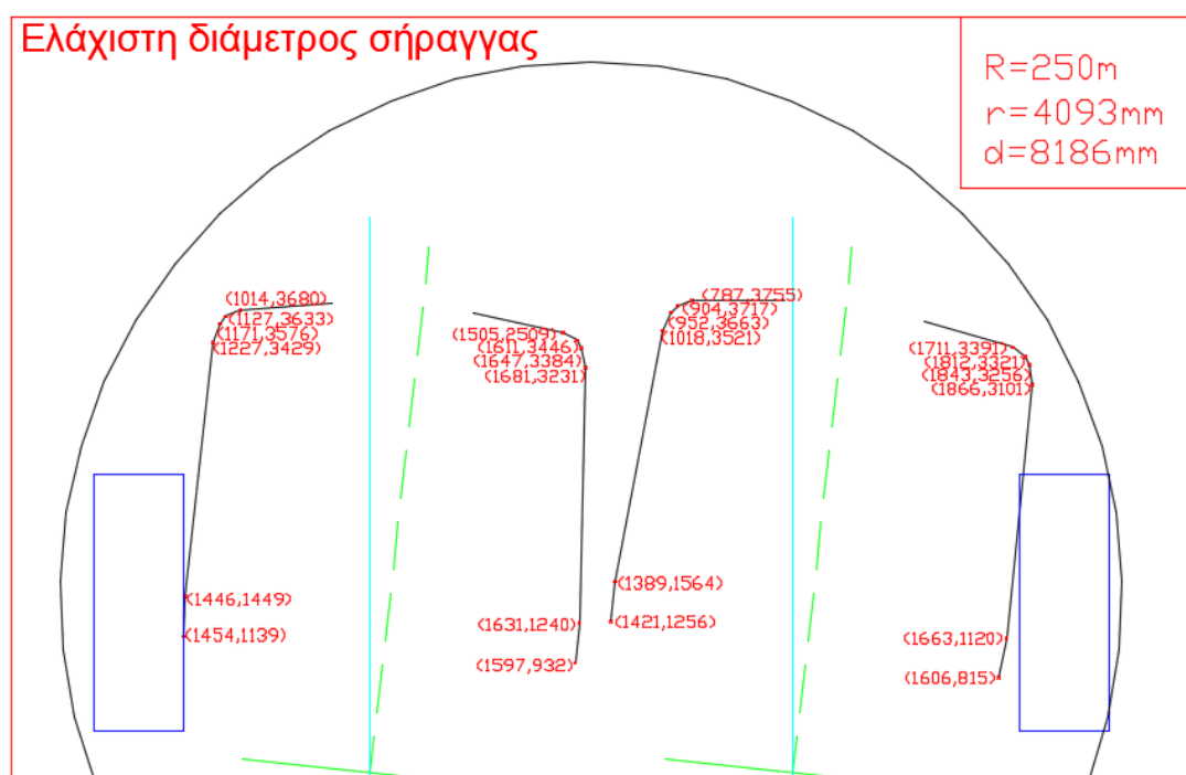
Σχήμα 4.17: Διατομή κινηματικών περιτυπωμάτων στη δυσμενέστερη θέση για το εσωράχιο της σήραγγας για οριζοντιογραφική ακτίνα R=250m
