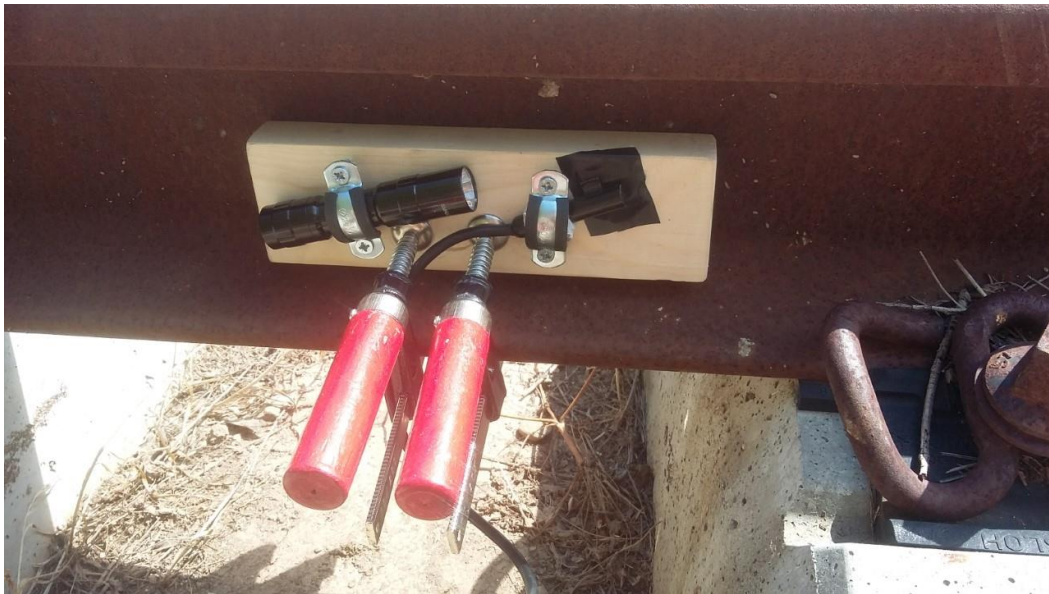
Εικόνα 3.2: Τοποθετημένη μικροκάμερα επί της σιδηροτροχιάς
