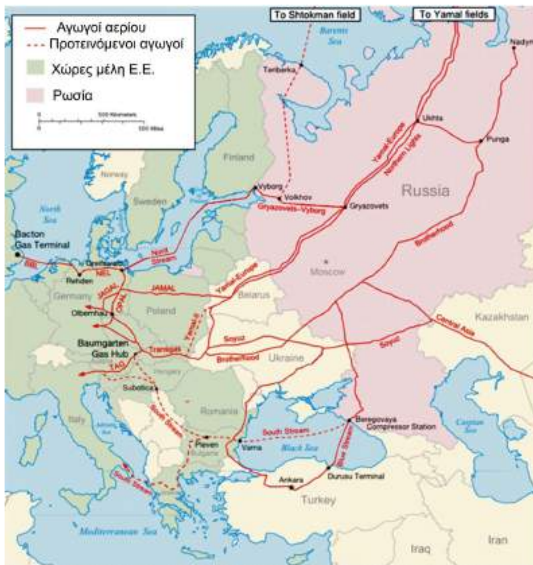
Σχήμα 39: Κύριοι αγωγοί τροφοδοσίας Ευρώπης με προέλευση τη Ρωσία. 49
