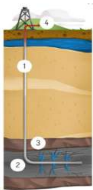
Σχήμα 21: Βήματα εξόρυξης σχιστολιθικού αερίου. 36
