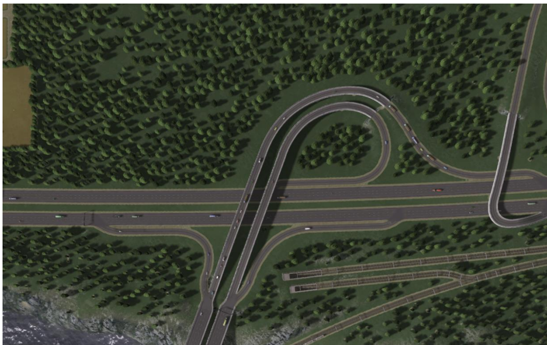
Σχήμα 2.4 Φωτογραφία ανισόπεδου κόμβου μορφής Σάλπιγγας (Δεξιάς) ( http://imgur.com )
