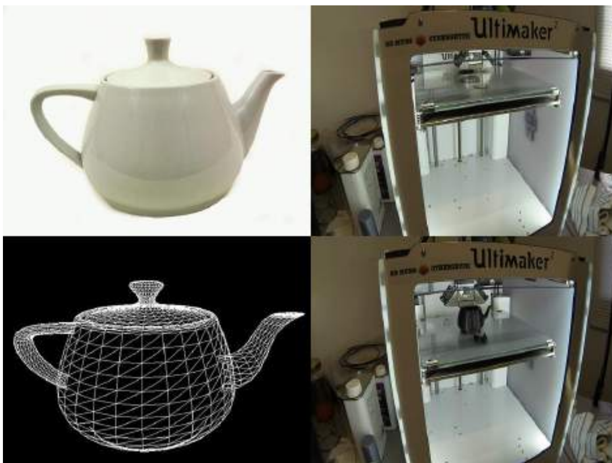
Εικόνα 32 Πραγματική Τσαγιέρα, Τρισδιάστατο Μοντέλο και Τρισδιάστατη Εκτύπωση
