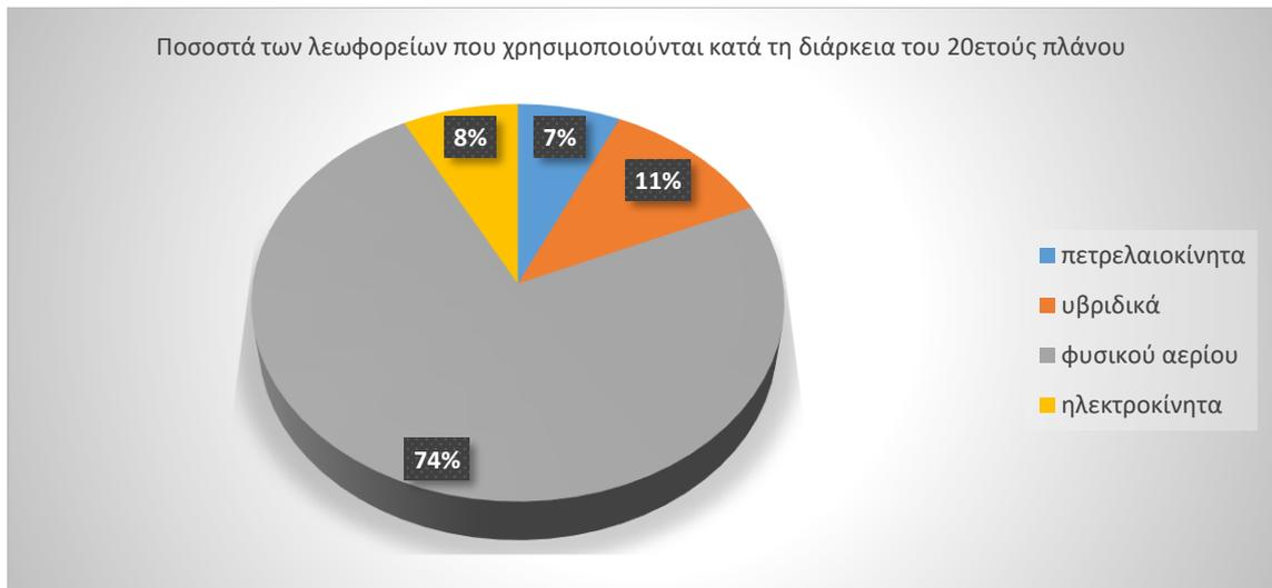
**Σχήμα 5.24:** Ποσοστά των διαφόρων τύπων λεωφορείων που χρησιμοποιούνται κατά τη διάρκεια του 20ετούς πλάνου για υψηλό κόστος αγοράς ηλεκτροκίνητων
