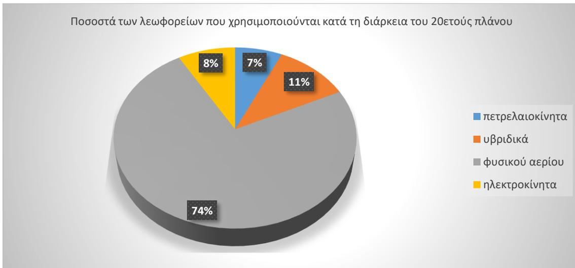
**Σχήμα 5.32:** Ποσοστά των διαφόρων τύπων λεωφορείων που χρησιμοποιούνται κατά τη διάρκεια του 20ετούς πλάνου για υψηλό κόστος ηλεκτρισμού
