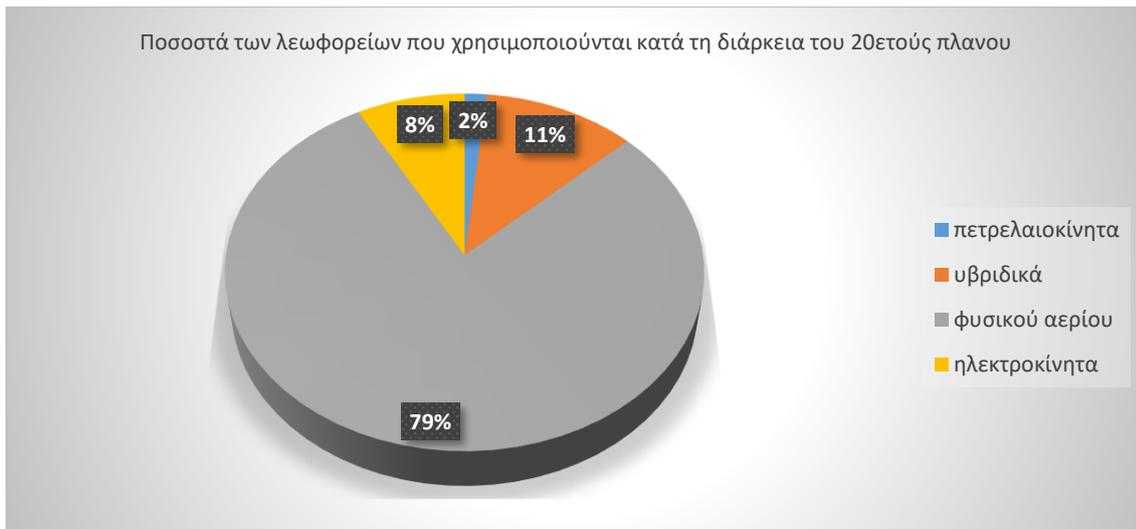
**Σχήμα 5.34:** Ποσοστά των διαφόρων τύπων λεωφορείων που χρησιμοποιούνται κατά τη διάρκεια του 20ετούς πλάνου για χαμηλό κόστος φυσικού αερίου
