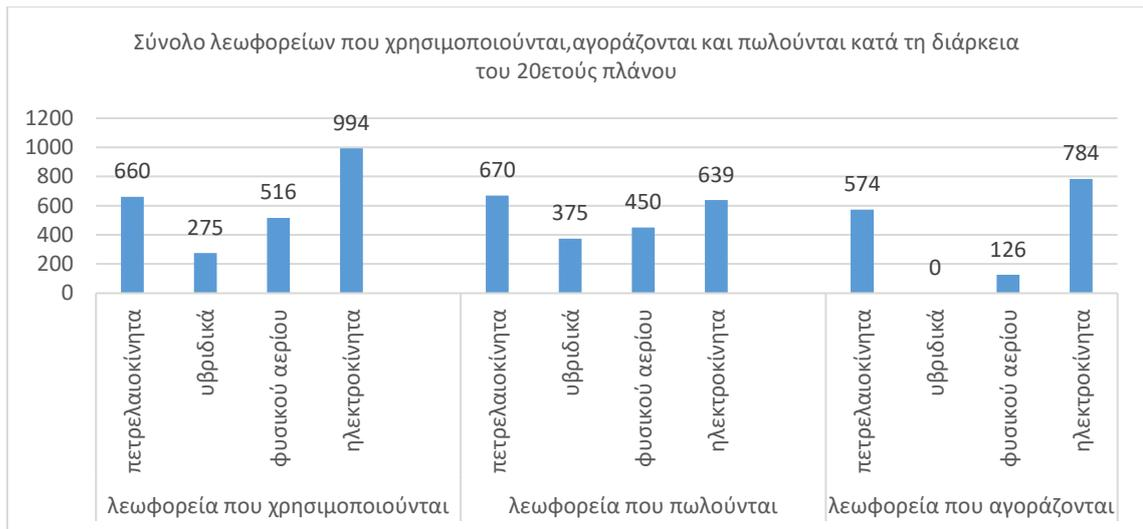
**Σχήμα 5.11:** Συνολικός αριθμός των διαφορετικών λεωφορείων κάθε τύπου που χρησιμοποιούνται, αγοράζονται και πωλούνται κατά τη διάρκεια του 20ετούς πλάνου για χαμηλό κόστος αγοράς πετρελαιοκίνητων
