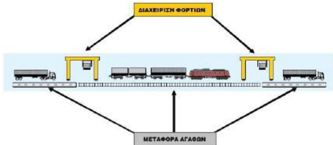
Σχήμα 4: Τυπική δομή ενός Εμπορευματικού Κέντρου Συνδυασμένων Μεταφορών
