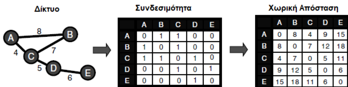
Σχήμα 5: Κατασκευή πίνακα συνδεσιμότητας ενός μεταφορικού δικτύου
