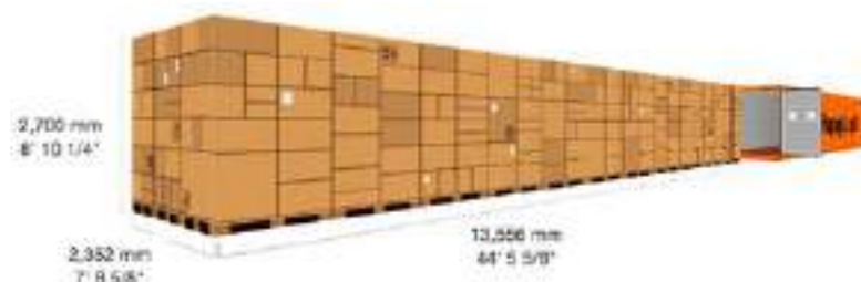
Εικόνα 10: Τυπικές Εσωτερικές διαστάσεις και χωρητικότητα ενός pallet-wide container 45'
