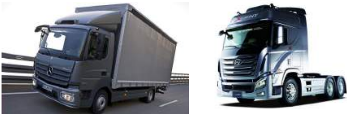
Εικόνα 13: Φορτηγό διαξονικό (αριστερά) και ρυμουλκό τριαξονικό όχημα (δεξιά)
