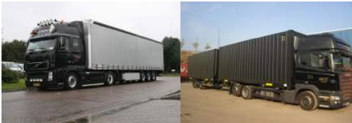
Εικόνα 14: Αρθρωτό όχημα (αριστερά) και οδικός συρμός με 2 ρυμουλκούμενα (δεξιά)
