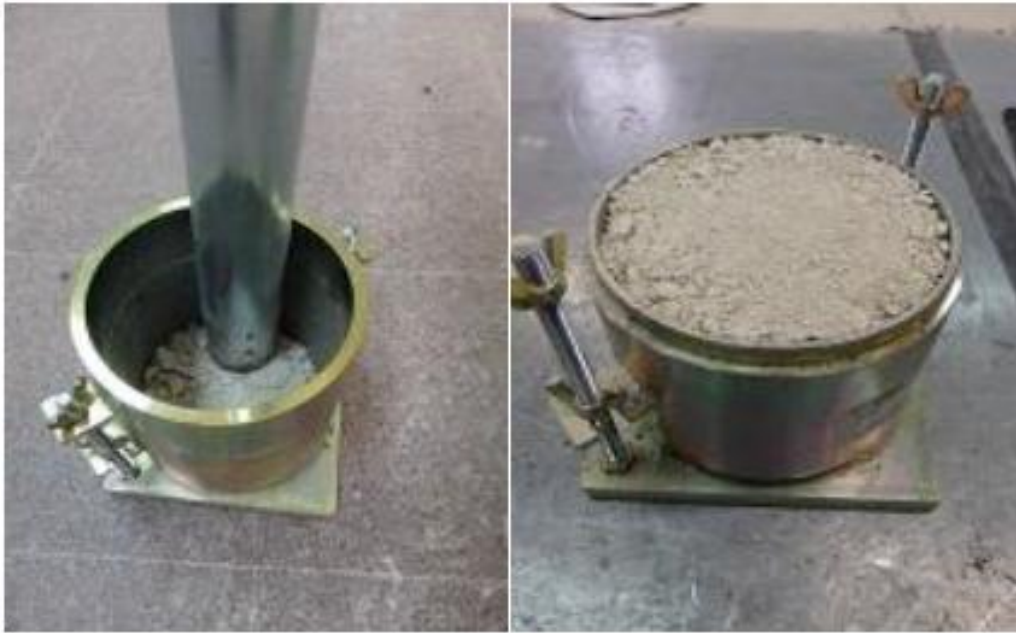
Εικόνα 3.3 Μήτρα δοκιμής Proctor και κόπανος συμπίκνωσης.
