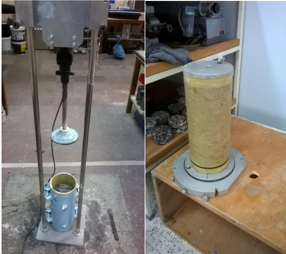
Εικόνα 3.6 Συμπύκνωση με δονητική συσκευή και τοποθέτηση δοκιμίου στη βάση του τριαξονικού κελιού.
