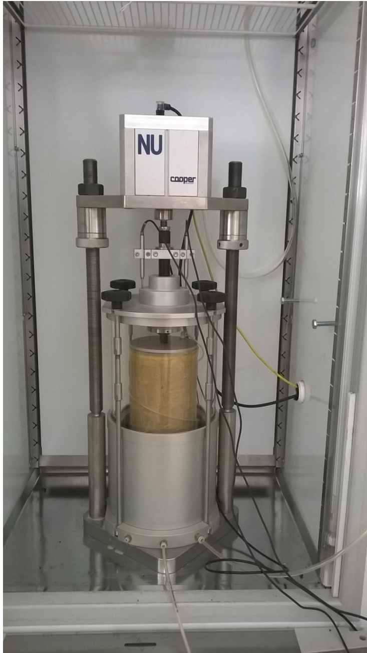
Εικόνα 3.10 Δοκίμιο τοποθετημένο στο θάλαμο φόρτισης.
