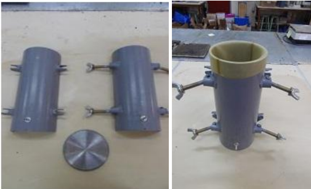
Εικόνα 3.5 Καλούπι κατασκευής δοκιμίου και τοποθέτηση μεμβράνης
