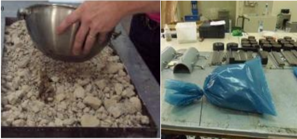
Εικόνα 3.4 Ανάμιξη υλικού με νερό και τοποθέτηση σε πλαστική σακούλα
