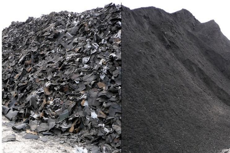
Εικόνα 4-3 Ανακυκλωμένες ασφαλτικές πλάκες στεγών πριν και μετά (RAS)
