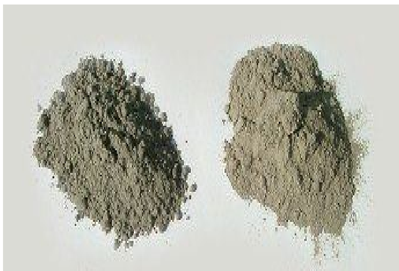
Εικόνα 4-4 Ιπτάμενη τέφρα δεξιά σε σύγκριση με συμβατικό τσιμέντο αριστερά
