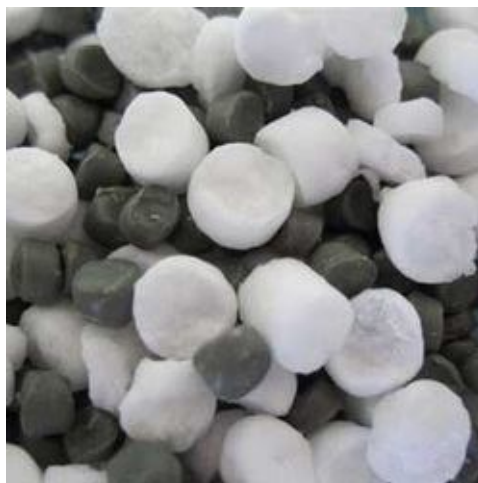
Εικόνα 4-5 Ασφαλτος τροποποιημένη με πολυμερή PMA
