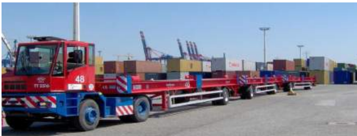
Εικόνα 6 Ελκυστήρες με δυνατότητα ρυμούλκησης πολλών τρέιλερ [Πηγή: Buisca, Cargo Solutions, http://www.buisca.com/mts.htm , τελευταία πρόσβαση 10/9/2015.]
