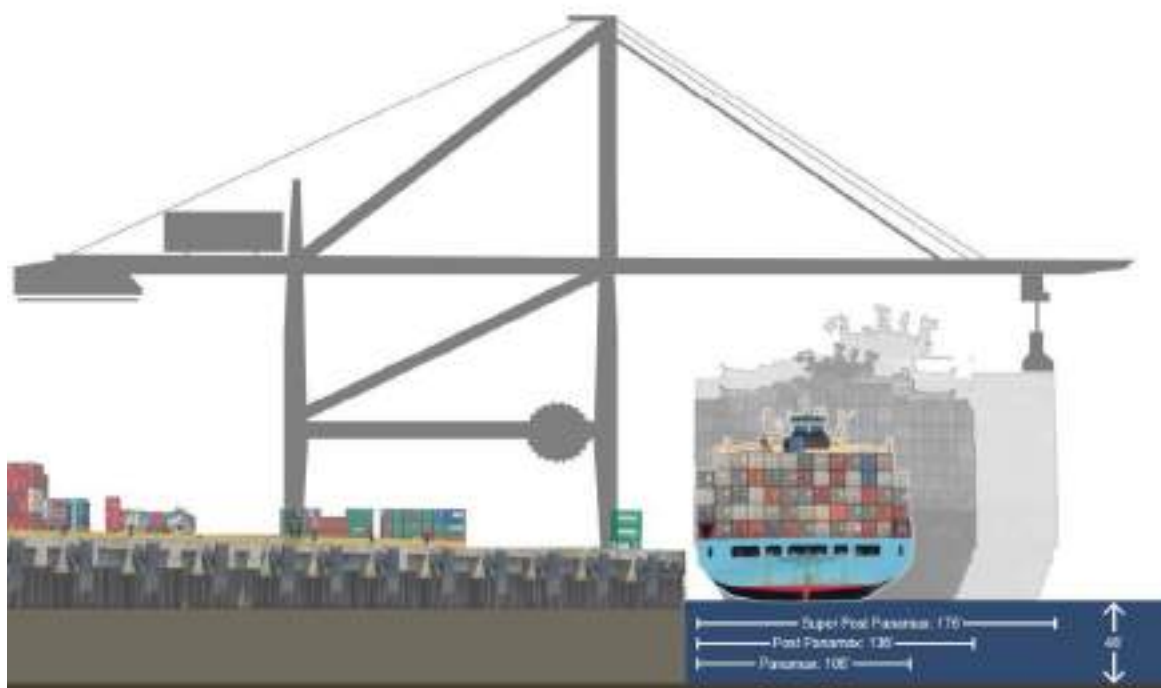
Εικόνα 3 Εξέλιξη γερανών θαλάσσιας πλευράς [Πηγή: Edmonds, R. (2010)]
